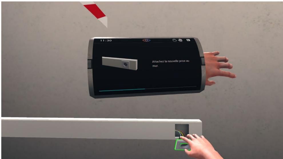
Le remplacement de la prise a été effectué. Le cadenas et le grip de consignation peuvent être retirés du disjoncteur et rangés dans la boîte à outils et le disjoncteur peut être réenclenché.
