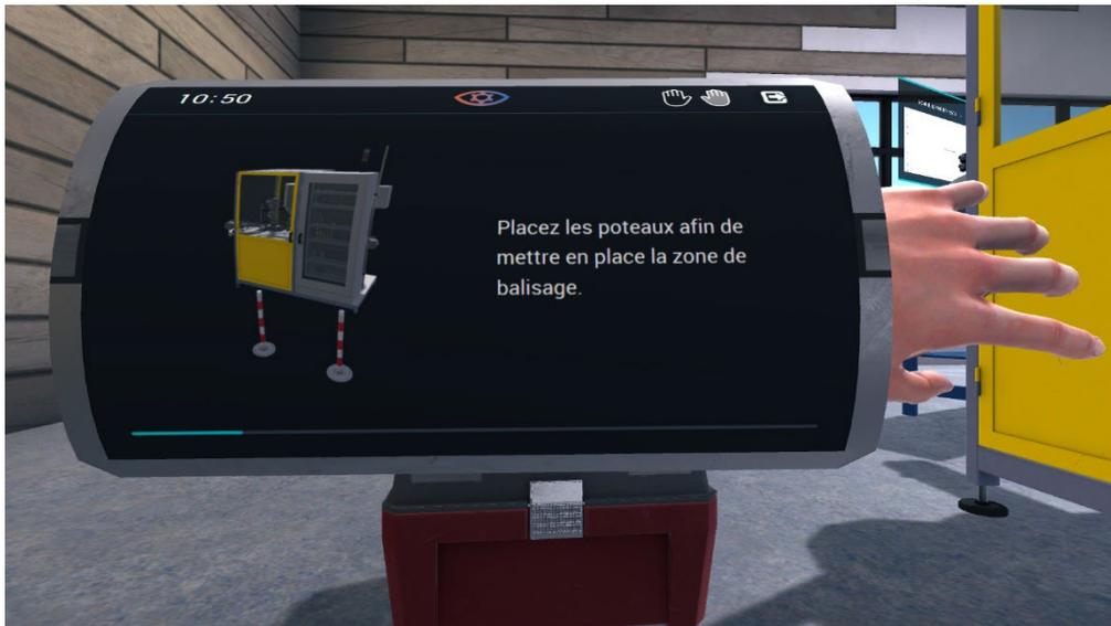
Une fois les poteaux posés, l'apprenant doit ensuite poser la bannière adéquate sur l'un des poteaux. La zone de balisage est finalisée et la bannière utilisée s'attache correctement à la porte de l'armoire électrique et aux poteaux.
