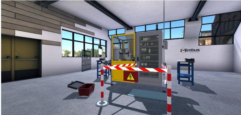
Le balisage étant en place, l'apprenant doit dans l'étape qui suit localiser l'intersectionneur Q1 qu'il devra consigner. Pour ce faire, il doit pointer sur Q1 et appuyer sur la gâchette du contrôleur. L'intersectionneur se mettra à clignoter s'il n'est pas localisé dans les 20 secondes dans le mode de difficulté **DEBUTANT**.
