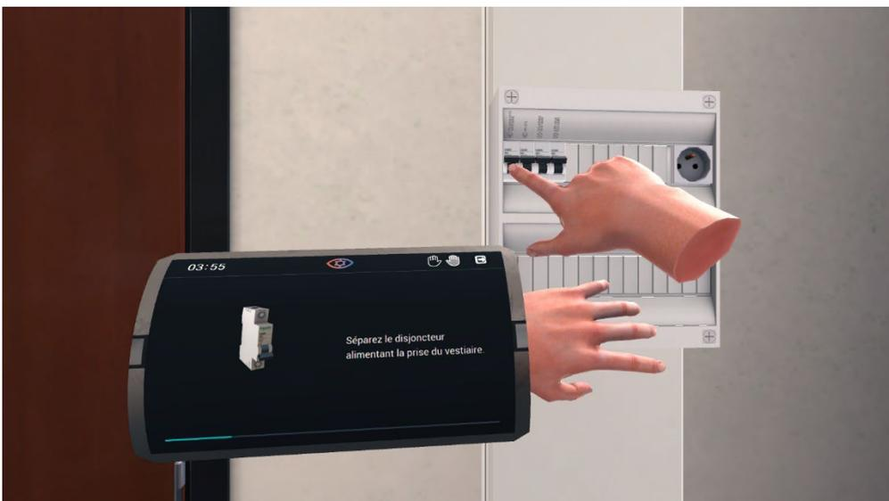
Pour éviter tout réenclenchement accidentel du disjoncteur, il est nécessaire de déposer sur celui-ci un grip de consignation, puis un cadenas de consignation. Il faut saisir ces deux objets depuis l'inventaire à tour de rôle et les déposer sur le disjoncteur séparé. Le grip ne pourra pas être déposé sur le disjoncteur si celui-ci n'a pas été préalablement sectionné.
