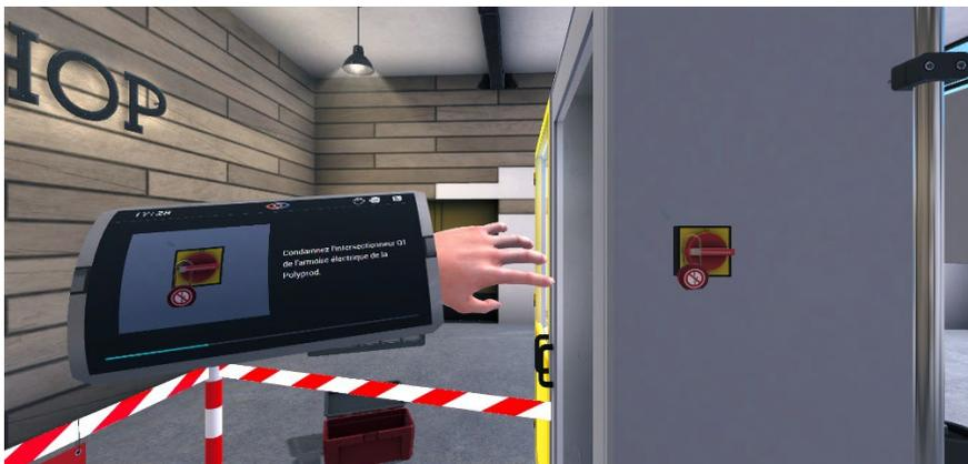
Lors de l'étape suivante, il est demandé d'identifier sur le schéma visible sur la tablette le départ électrique qui vient d'être consigné. La tablette doit être saisie d'une main et un clic dans la zone représentant le sectionneur Q1 doit être effectué.
