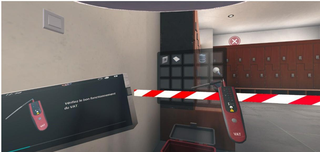
Les LEDs de l'appareil s'allument et un son retentit, qui prouvent le bon fonctionnement de l'appareil.
