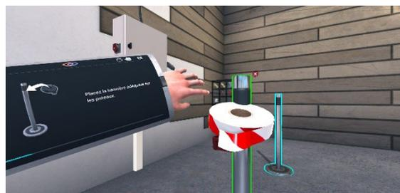
La zone de balisage étant en place, l'apprenant doit à présent tester l'étanchéité de ses gants. Pour ce faire il doit attacher le testeur de gant sur chacun des deux gants pour les remplir d'air.
