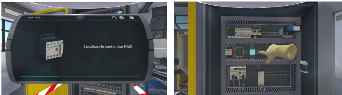
À partir du niveau **AVANCÉ**, si le contacteur n'est pas repéré par l'apprenant dans les 20 secondes, le système déclenchera une erreur fatale qui amènera à l'échec de la séquence. Maintenant que le contacteur KM2 est repéré, il faut couvrir la zone de voisinage en posant une nappe isolante.
