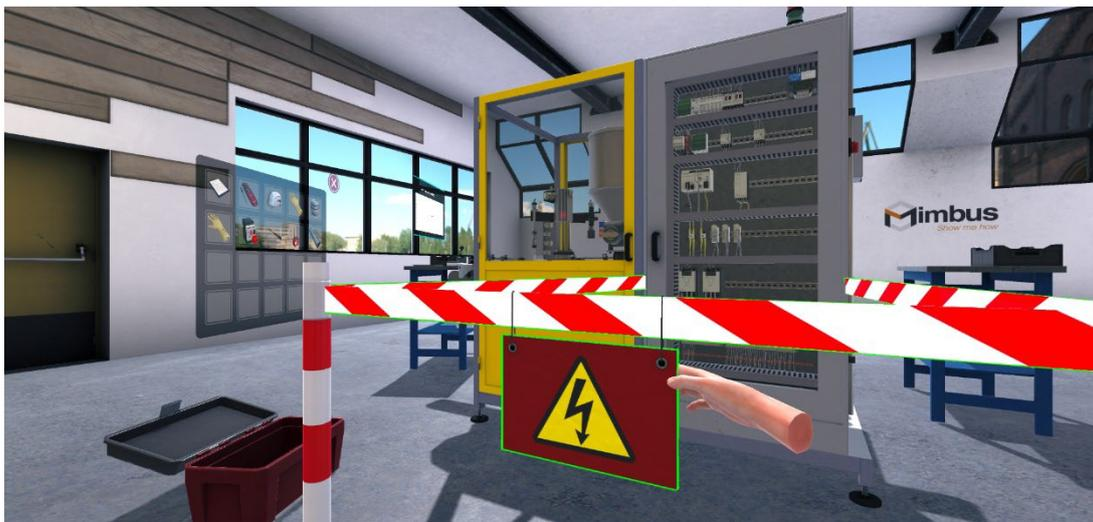
L'apprenant doit maintenant vérifier le bon fonctionnement de la machine, en particulier du système de distribution de bouchons. Il doit ouvrir la vanne pneumatique, réarmer la machine, lancer l'initialisation puis mettre en marche la machine une fois l'initialisation terminée.
