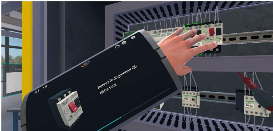
Une fois le disjoncteur Q6 neuf en place, il faut régler son calibre via la vis en plastique en façade. A l'aide du tournevis isolé, il est possible de régler sa valeur en l'attachant sur cette vis par un clic sur la gâchette et en effectuant une rotation de la main tenant le tournevis. Un guide visuel apparaît alors et permet de visualiser la valeur de calibrage courante. Le disjoncteur Q6 doit être réglé avec un calibre de 0.4A.
