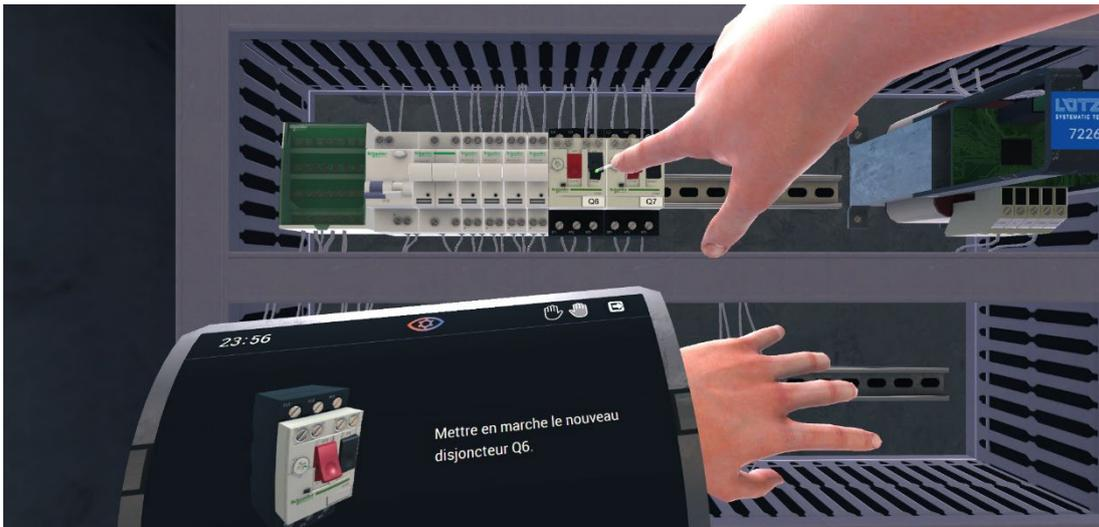
L'intervention terminée, l'apprenant peut refermer l'armoire de la Polyprod et remettre l'armoire sous tension en réenclanchant le sectionneur Q1 après avoir retiré le cadenas de condamnation. Il peut enfin retirer le tapis isolant et le balisage de la zone d'intervention.
