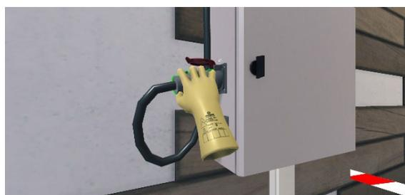
Une fois la prise branchée, l'apprenant doit vérifier le bon fonctionnement de la prise installée. Pour ce faire il doit dans un premier temps remettre l'armoire sous-tension en réenclenchant le sectionneur Q1, puis pointer et cliquer sur la vérine blanche de la Polyprod.
