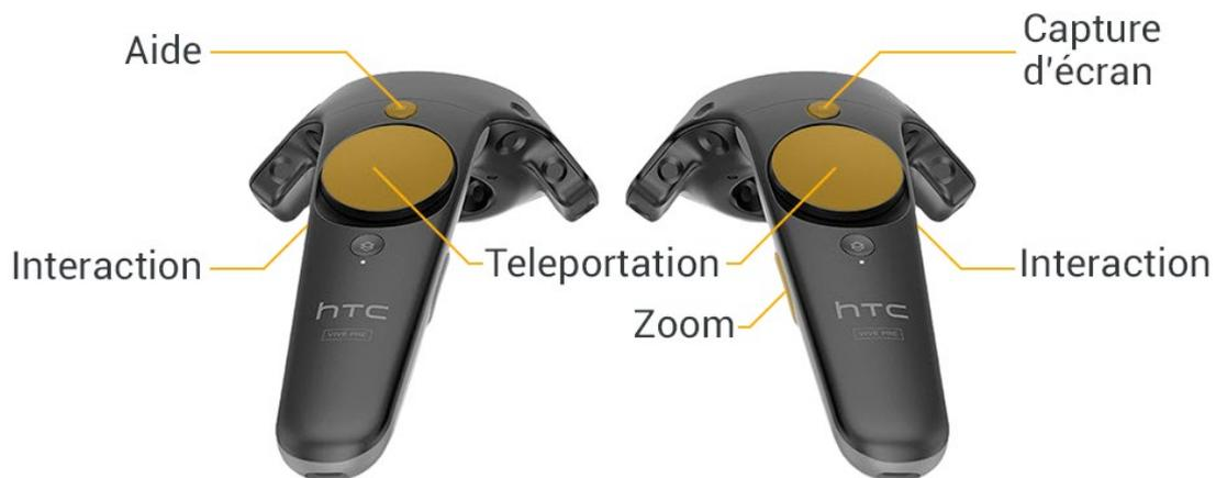
Figure 2 - Configuration des touches des contrôleurs
