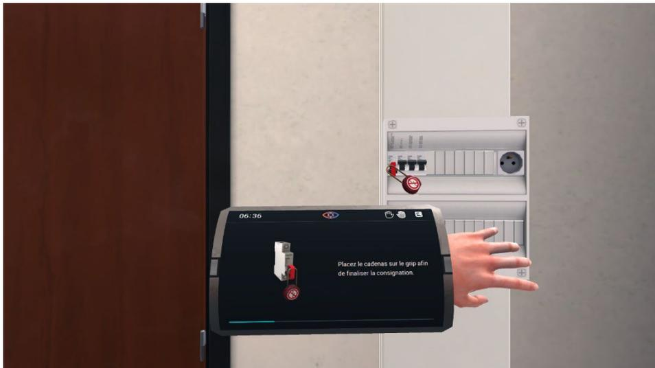
L'apprenant doit maintenant identifier le disjoncteur qui vient d'être consigné sur le schéma électrique. Le schéma est visible sur la tablette et l'étape est validée lorsque l'apprenant clique sur le bon disjoncteur sur ce schéma, à l'aide de la main qui ne tient pas la tablette.
