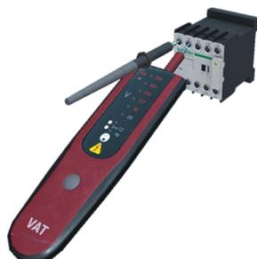
Pour tester les bornes des éléments électriques de l'armoire, il faut approcher chacune des deux bornes du VAT aux bornes des éléments électriques de l'armoire, jusqu'à ce que celles-ci soient entourées d'une silhouette, symbolisant la possibilité d'effectuer le test. Afin de réaliser ce test, l'apprenant n'a plus qu'à appuyer sur les gâchettes d'interactions respectives des contrôleurs.
