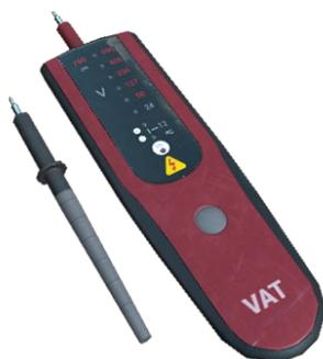
Le vérificateur d'absence de tension permet de vérifier l'absence de tension, comme son nom l'indique. Pour saisir cet outil, il faut avoir les deux contrôleurs libres. Le VAT est constitué de deux bornes. Le corps principal de celui-ci indique si une tension est détectée.
