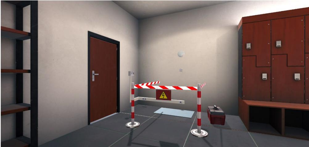
Il faut maintenant le séparer le disjoncteur qui alimente la prise du vestiaire par un clic sur ce dernier au niveau du panneau électrique présent à droite de la porte des vestiaires.
