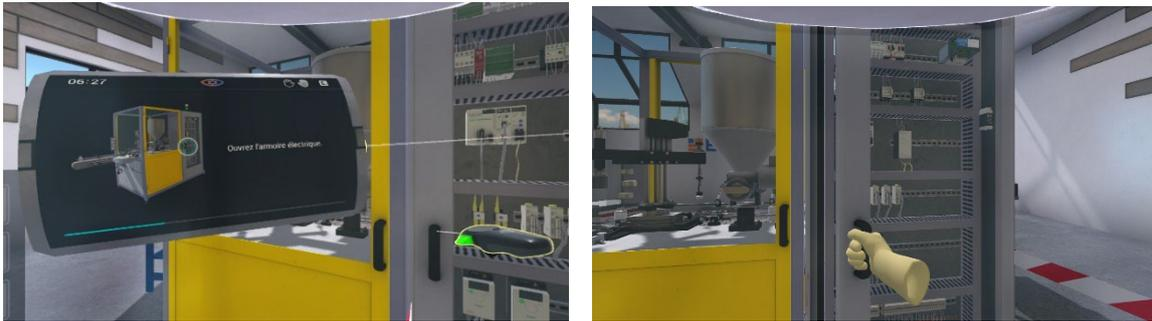
Au niveau **EXPERT**, les étapes de balisage de la zone d'intervention, du testage des gants, d'équipement des EPI, de placement du tapis isolant et d'ouverture de la porte se présentent sous l'intitulé "Préparez l'intervention".
