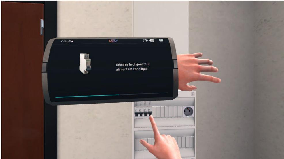
Pour éviter tout réenclenchement accidentel du disjoncteur, il est nécessaire de déposer sur celui-ci un grip de consignation, puis un cadenas de consignation. Il faut saisir ces deux objets depuis l'inventaire à tour de rôle et les déposer sur le disjoncteur séparé. Le grip ne pourra pas être déposé sur le disjoncteur si celui-ci n'a pas été préalablement sectionné.
