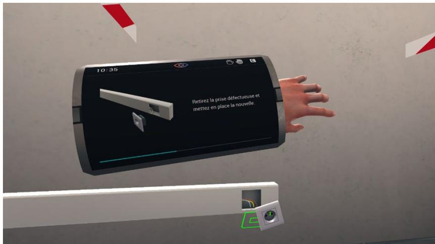
Les trois vis de la nouvelle prise doivent être vissées afin d'y attacher les trois fils, à l'aide du tournevis isolé.
