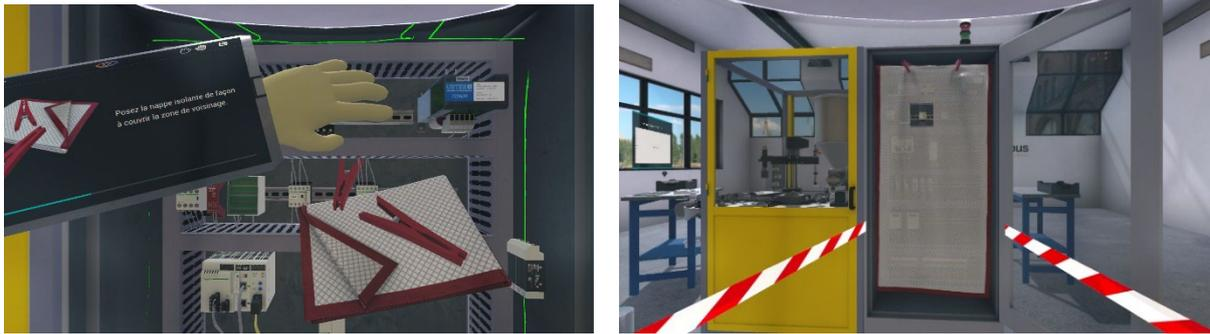
Une fois le voisinage couvert, l'apprenant doit maintenant vérifier l'absence de tension en amont du contacteur KM2. Pour ce faire il utilise le VAT et doit d'abord vérifier son fonctionnement en l'auto testant.
