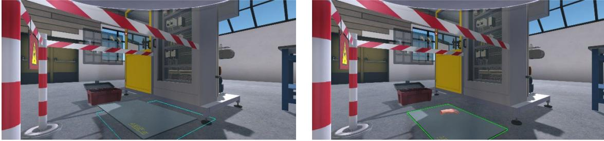
Lorsque le tapis isolant est placé devant l'armoire électrique l'apprenant peut et doit maintenant ouvrir la porte de l'armoire électrique afin de commencer son intervention.
