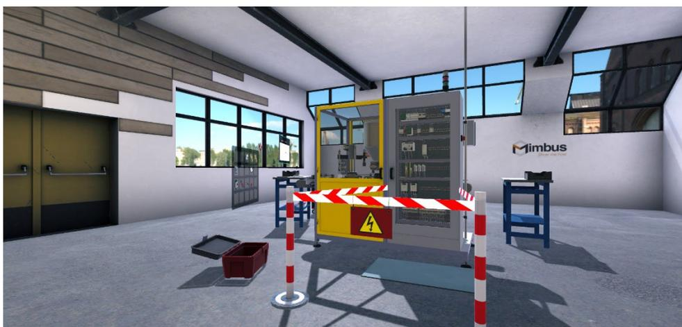
L'étape suivante consiste en la séparation du sectionneur Q1. Pour le mettre en position OFF afin de couper l'alimentation électrique de la Polyprod, il suffit de le saisir et d'effectuer une rotation de 90° de la main vers la gauche.
