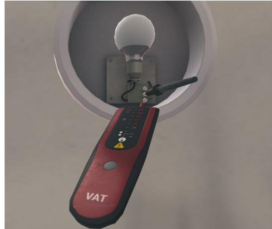
Pour être absolument certain de l'absence de tension, on bascule l'interrupteur et on réitère la procédure de vérification d'absence de tension (autotest du VAT, test des trois bornes, puis autotest)
