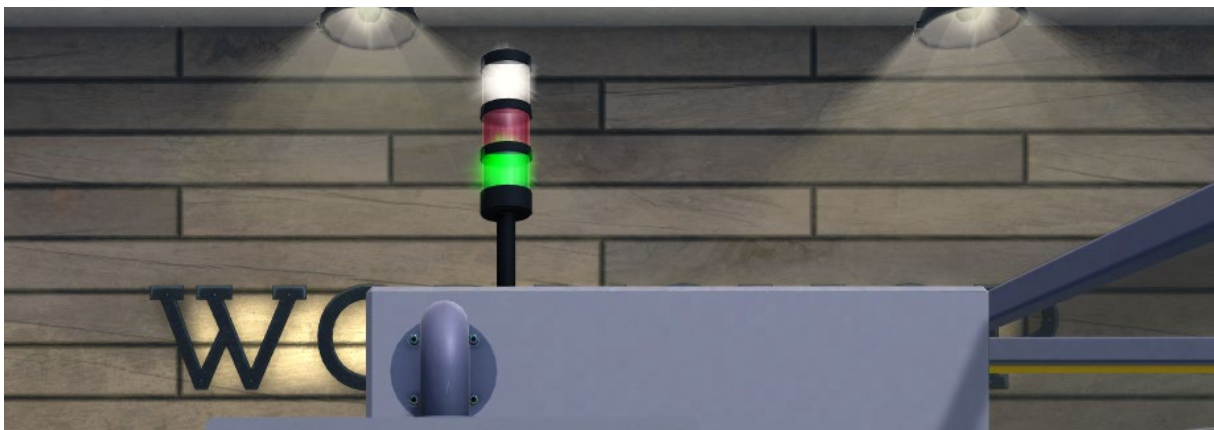
Figure 20 - État des verrines lors d'un bon fonctionnement de la machine
