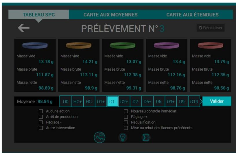
Par exemple dans le cas où la moyenne du prélèvement effectué se situe dans la zone bleue (zone de contrôle renforcée), si le prélèvement précédent n'était pas dans la même situation, le code de dérive de la situation actuelle est D1-.
