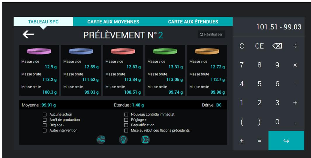
Il est demandé à l'apprenant de calculer chacune des masses nettes des flacons bagués, la moyenne du prélèvement et enfin l'étendue. Pour ce faire, il doit utiliser la calculatrice qui se trouve à côté du tableau de prélèvement. Les **formules de calcul** lui sont disponibles à la consultation (troisième icône en partant de la gauche).
