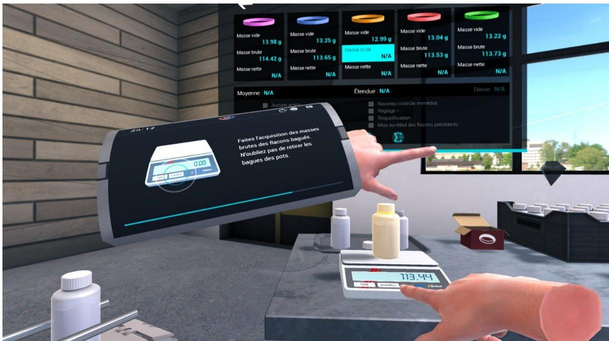
Une fois toutes les masses brutes acquises, les bagues doivent être retirés des pots : il faut saisir chaque pot bagué et le relâcher sur la boîte des bagues. Les flacons peuvent ensuite être déposés dans le bac en sortie de la Polyprod.
