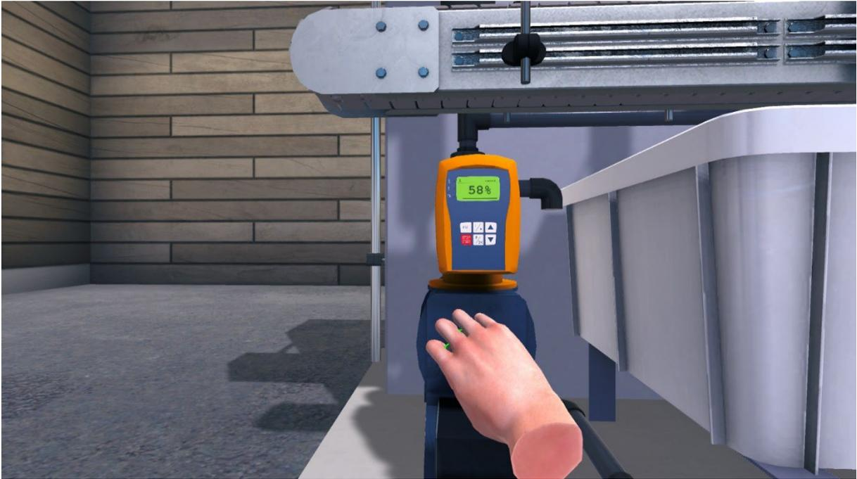
L'étape suivante consiste en la « tare collective » de la balance. Il faut déposer sur la balance un pot vide ainsi qu'un bouchon et appuyer sur le bouton « Tare » de la balance.
