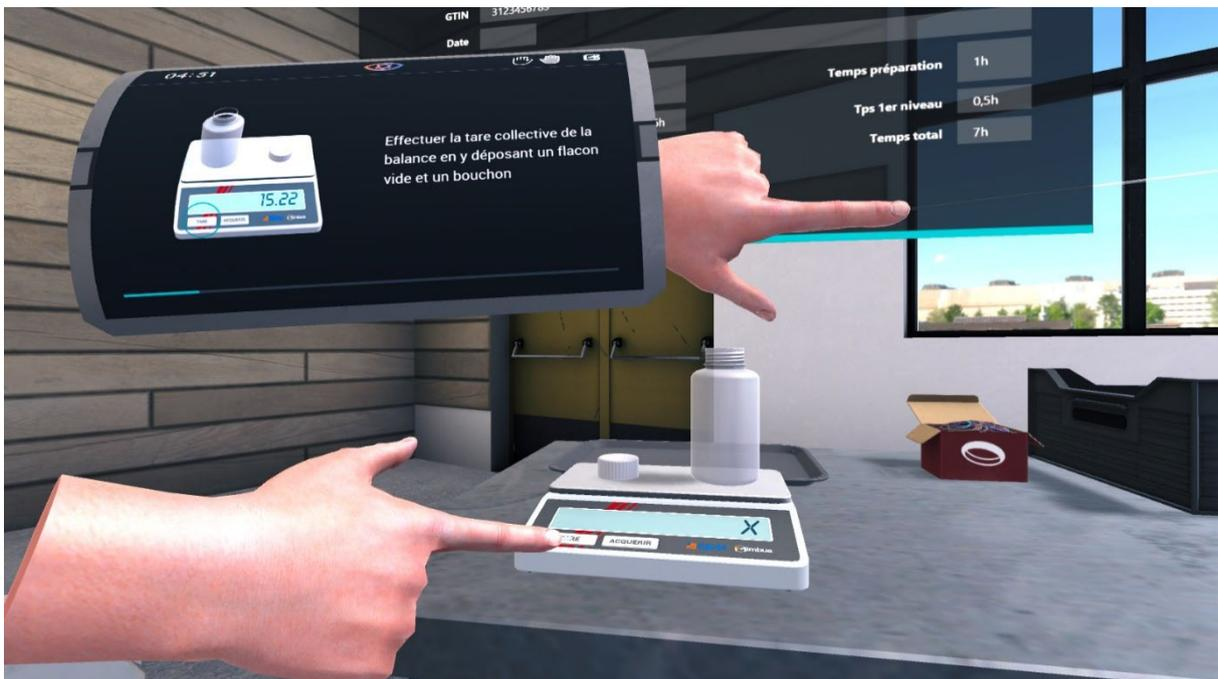
La machine doit être mise en marche et un flacon doit être prélevé. Pour valider l'étape, il faut prendre un flacon en sortie de la machine Polyprod puis le déposer sur la balance. Si le flacon saisi n'a pas été produit avec les paramètres actuels de la machine, un message prévient l'utilisateur que le pot saisi n'est pas valide pour l'étape en cours.
