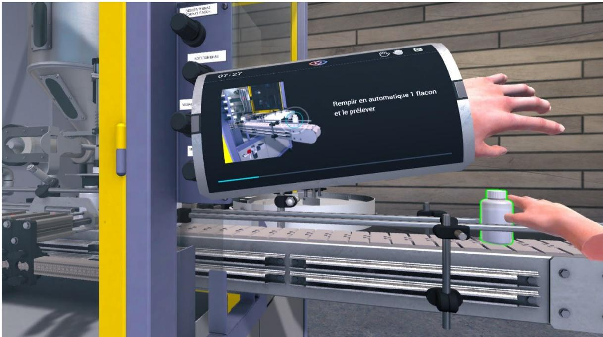
La masse du flacon est incorrecte, elle n'est pas dans l'intervalle 100.5g +/-1g (en niveau DEBUTANT et AVANCE) ou 125.5g +/-1g (en niveau EXPERT)
